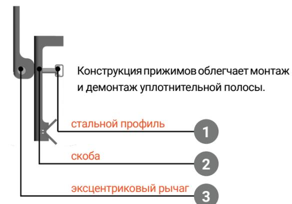
Конструкция прижимов облегчает монтаж и демонтаж уплотнительной полосы.
